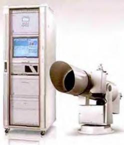
基于DOAS原理，用于监测环境空气中SO<sub>2</sub>、NO<sub>2</sub>、O<sub>3</sub>、甲醛、苯系物等气态污染物实时浓度。
