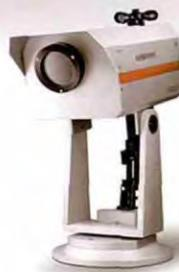
基于可调谐半导体激光光谱技术(TDLAS)用于测量大气中NH<sub>3</sub>、H<sub>2</sub>S、CO、CH<sub>4</sub>等气态污染物浓度。
