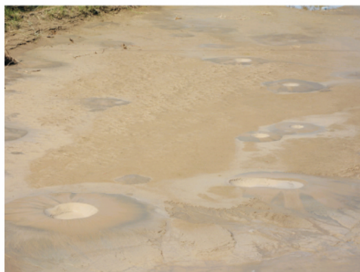
图 8 砂土液化现场调查照片
